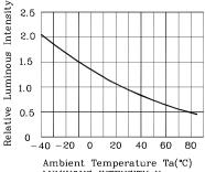
LUMINOUS INTENSITY Vs. AMBIENT TEMPERATURE
