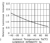
LUMINOUS INTENSITY Vs. AMBIENT TEMPERATURE
